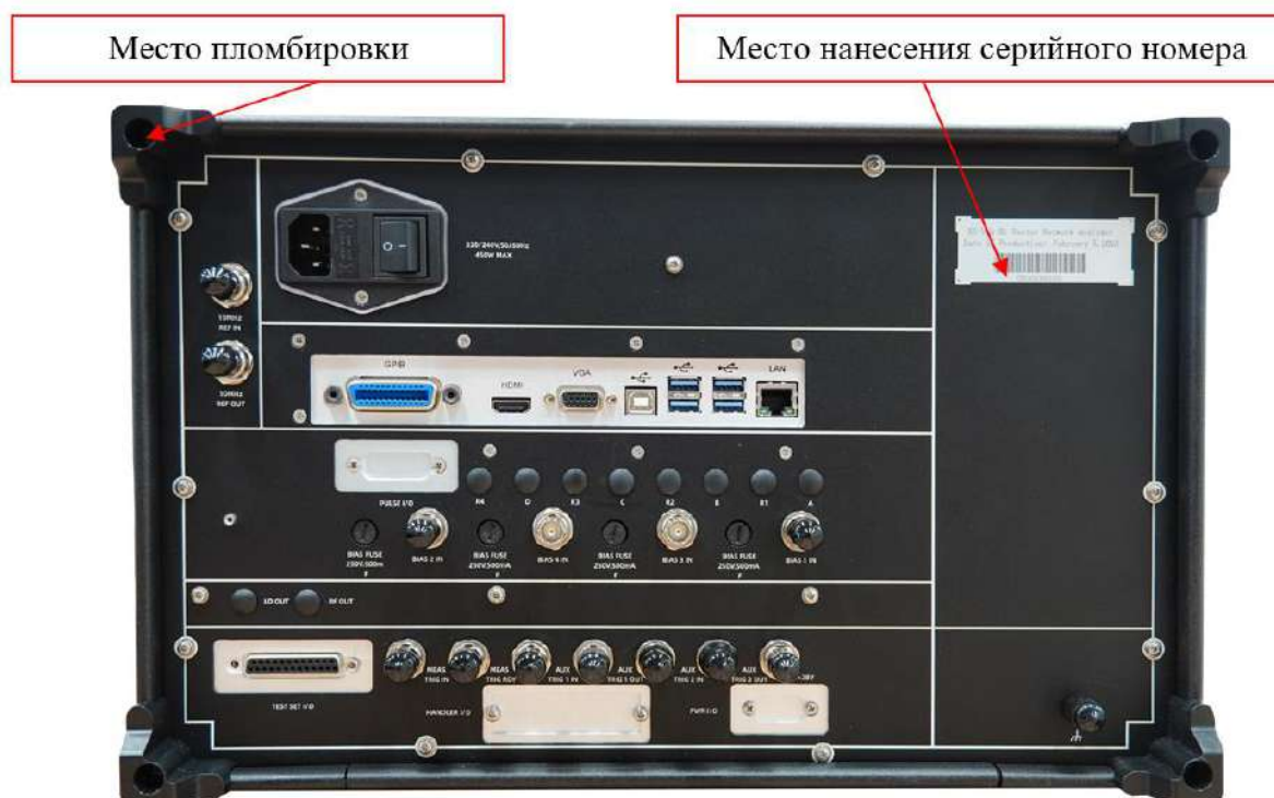
Рисунок 2 - Схема пломбировки от несанкционированного доступа и место нанесения серийного номера, идентифицирующего каждый экземпляр СИ
